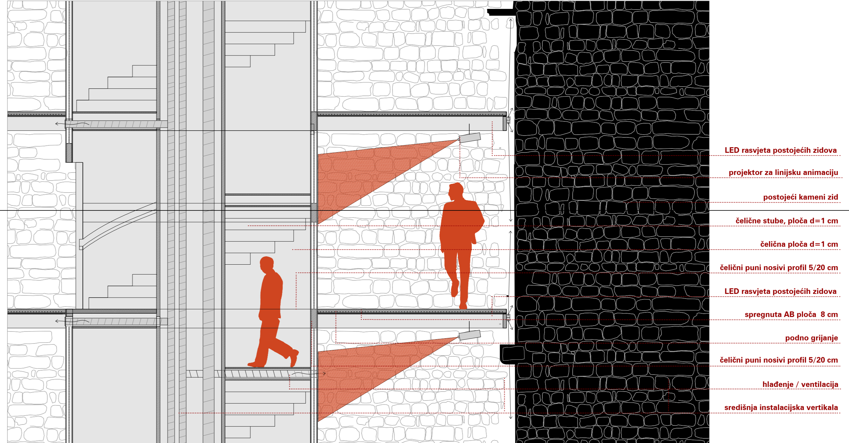
DETALJNI PRESJEK KROZ KULU KAMERLENGO M 1:33
